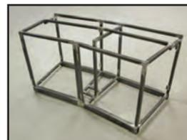
Estructura soldada y de suelo listo para la capa de pintura en polvo
